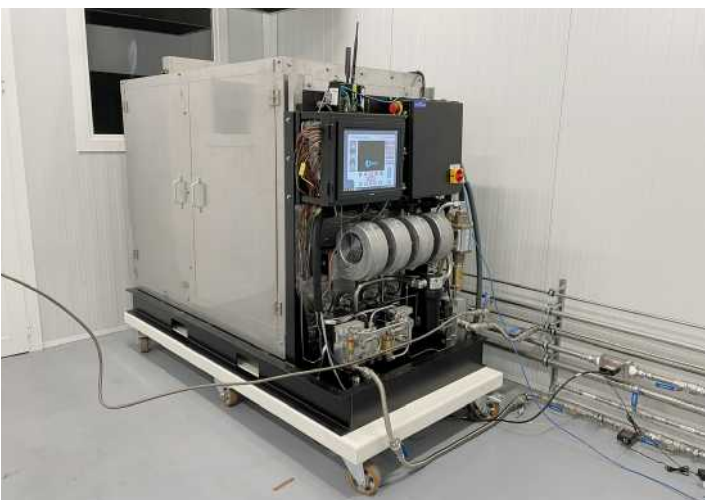
MMは、メタノールと水で水素を生成する「メタノールリフォーマー」の事業を開始した
